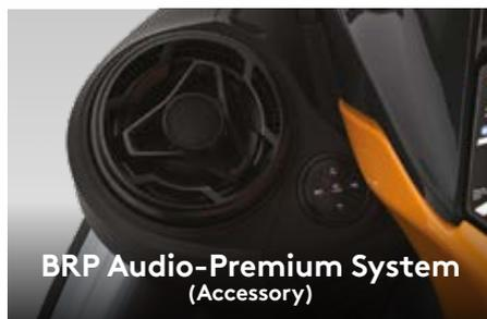
BRP Audio-Premium (доп. оборудование) — первая в отрасли действительно влагозащищенная аудиосистема Bluetooth<sup>®</sup>, устанавливаемая производителем.
