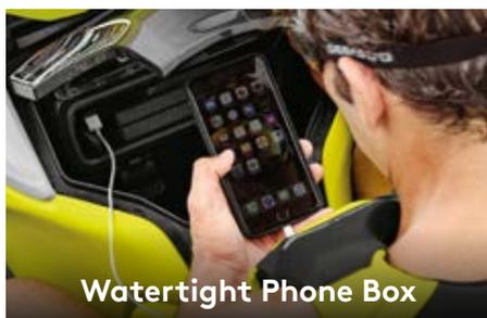
Защищенное от попадания воды и механических воздействий отделение, специально разработанное для размещения смартфона.
