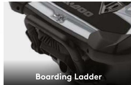
Посадочная подножка облегчает и ускоряет посадку на гидроцикл из воды.
